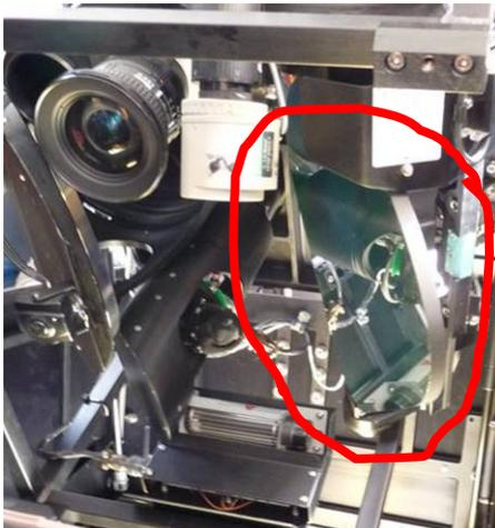
Balayage par système de miroir basculant
